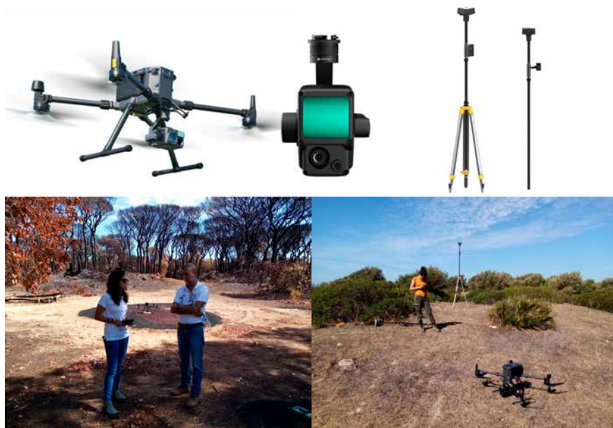
Figura 2. Equipamiento del Matrice 300 (dron, sensor, estación RTK) y trabajos de campo.
