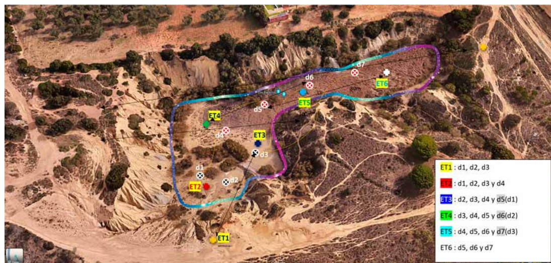
Figura 9. Itinerario de los estacionamientos (ET) del Escáner P50 y posición de dianas de control (d) en el escaneo de Los Barreros.
