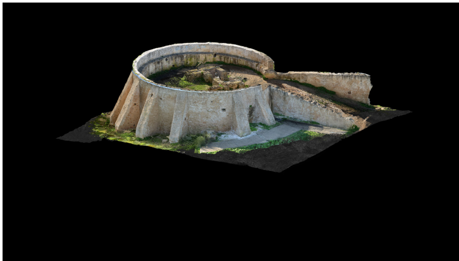
Figura 4. Modelización de la Noria con Escáner Láser Terrestre
