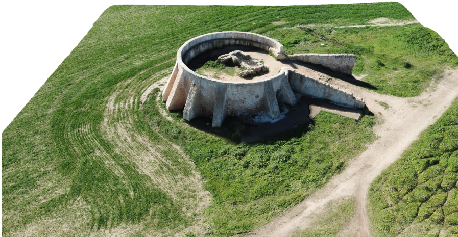
Figura 3. Modelización de la Noria con fotogrametría aérea y empleo de RPAS
