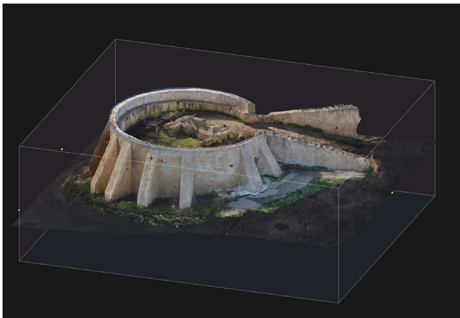
Figura 7. Modelización de la Noria con fotogrametría terrestre con equipo fotográfico profesional.
