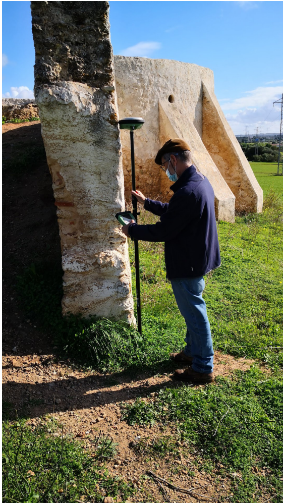
Figura 1. Trabajo de campo. Toma de datos con GPS de precisión.
